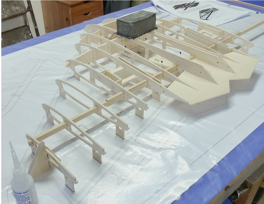
Die Rippen werden auf dem Holm aufgefädelt und nach dem Bauplan ausgerichtet. Die Stützfüßchen an den Rippen geben die korrekte Lage vor.
