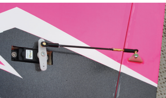
Stabil und spielfrei. Die Ruderanlenkung ist serienmäßig im Baukasten enthalten. Das 13-mm-Servo DS 340 BBMG von D-Power erfüllt seinen Zweck voll und ganz.
